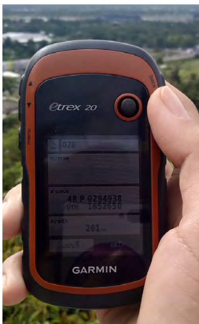
ภาพที่ 2.6 เครื่องกำหนดตำแหน่งพิกัดบนโลกด้วยดาวเทียม (GPS) แบบพกพา
